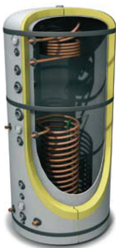
Akkumulatortank for tilkobling sol/ved/pellets fra den svenske leverandøren Effecta. Finnes i størrelser på 500 og 750 liter. www.effecta.se .
